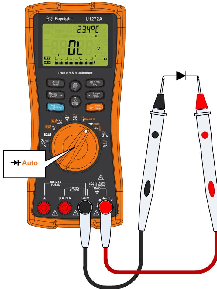
Рисунок 2-22 Проверка обратного смещения диода
