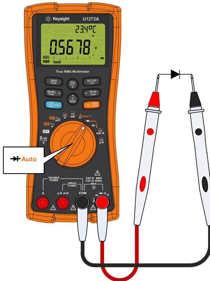
Рисунок 2-21 Проверка прямого смещения диода
