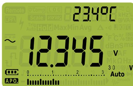
Рисунок 2-1 Экран для переменного напряжения
