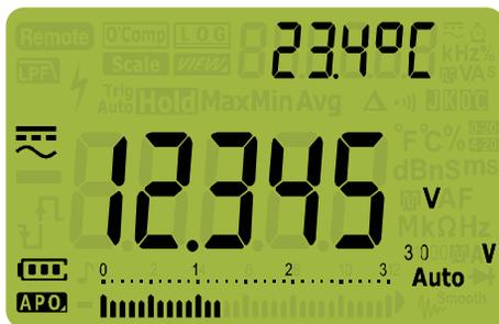
Рисунок 2-7 Экран для напряжения AC+DC
