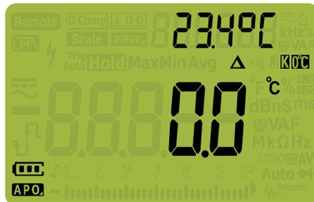
Рисунок 2-29 Измерение температуры без компенсации окружающей температуры
