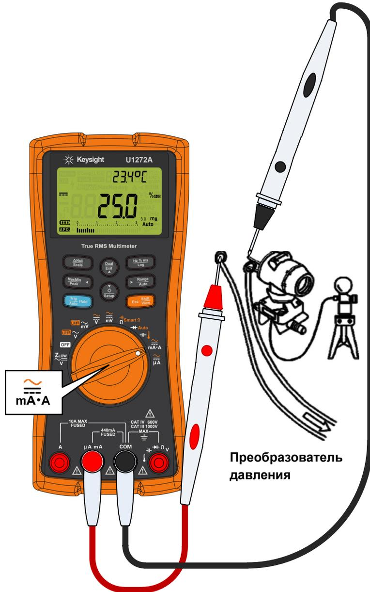
Рисунок 2-35 Измерение пост. тока в % шкалы 4–20 мА
