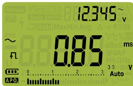
**Рисунок 2-39** Экран длительности импульса
