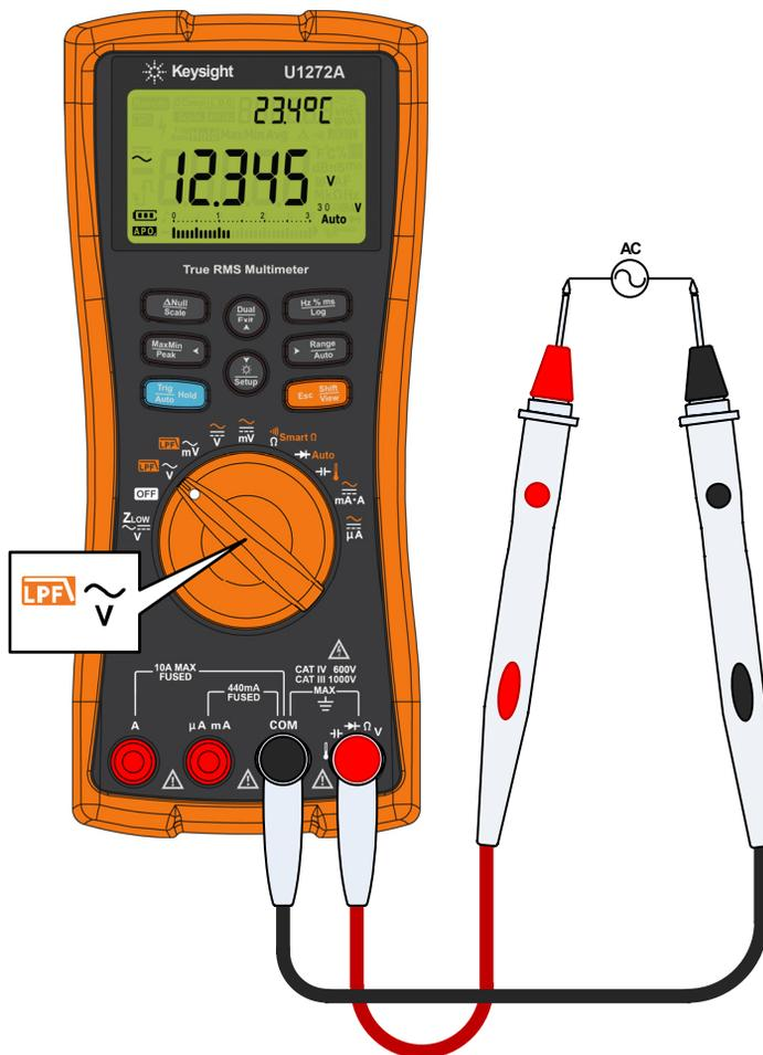
Рисунок 2-2 Измерение пер. напряжения
