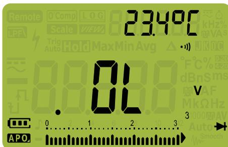
**Рисунок 2-20** Экран для хорошего диода
