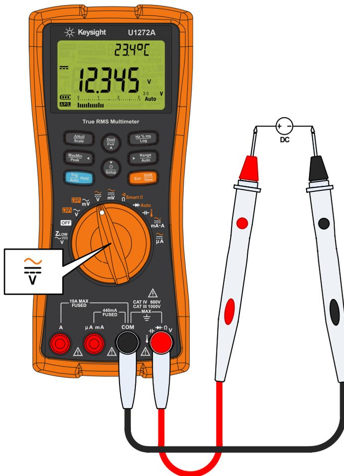
Рисунок 2-5 Измерение пост. напряжения
