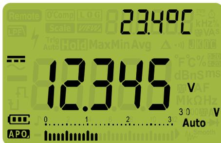
Рисунок 2-4 Экран для пост. напряжения
