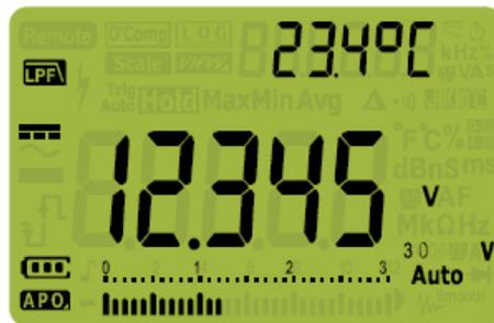
Рисунок 2-6 Фильтр для измерений пост. напряжения
