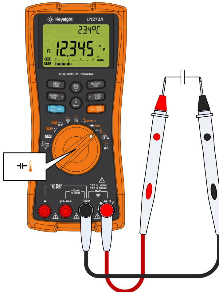
**Рисунок 2-26 Измерение емкости**
