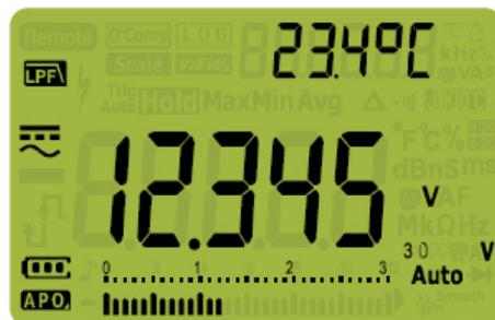
Рисунок 2-8 Фильтр нижних частот (LPF) при измерениях напряжения AC+DC
