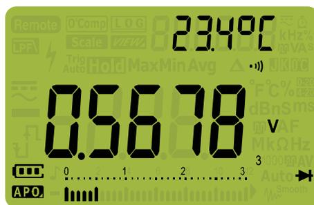
Рисунок 2-19 Экран проверки диода
