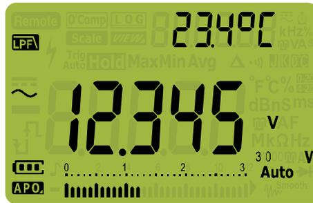
Рисунок 2-3 Отображение пер. напряжения с LPF
